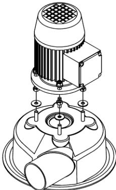
1. Motor an Gehäuse-Oberteil verschrauben
