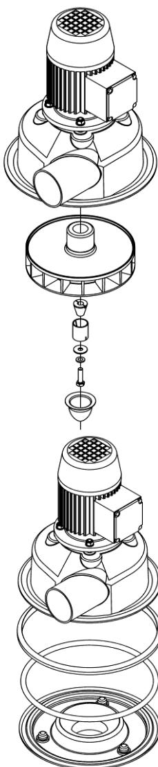
2. Laufrad aufsetzen, positionieren und festziehen
